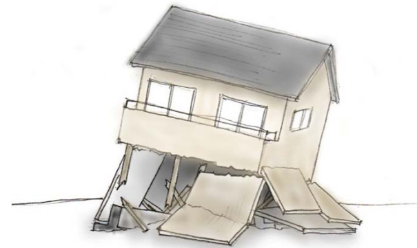
（基礎及び1階部分が崩れた住宅）
