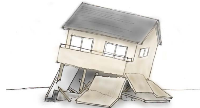
（基礎及び1階部分が崩れた住宅）
